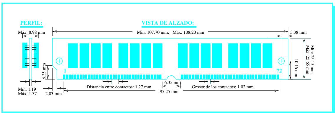
FIGURA 10.5: El formato SIMM de 72 contactos para un módulo de 32 chips (16 por cada cara) sin paridad. Cada chip contribuye con un único bit para formar la palabra de memoria del módulo. La simetría se rompe en el entrante que se habilita en la esquina inferior izquierda.
